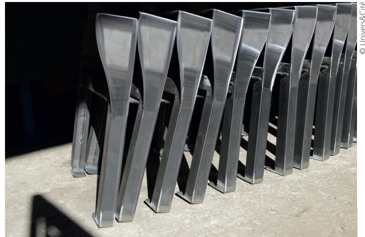
Aperçu des bancs 'Link' d'Univers&Cité, en cours de fabrication. Les pieds vont ici recevoir la finition (zingage et poudrage polyester cuit au four).
