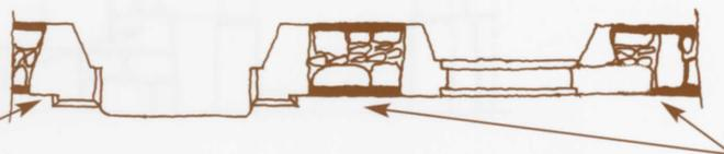
L'enduit couvre les surfaces ne devant pas rester apparentes.
